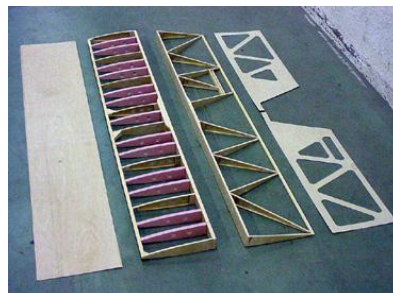
La structure du plan arrière horizontal assemblé et le revêtement prêt à coller
